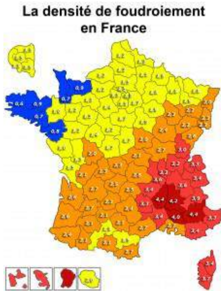
Figure 72 - Densité de foudroiement sur le territoire métropolitain (source : www.paratonnerres-radioactifs.fr )
